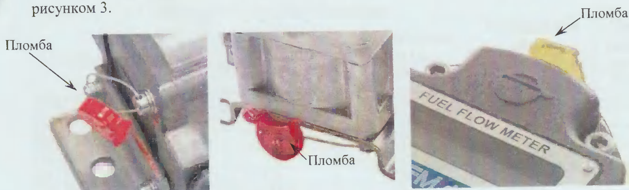
Рисунок 3 – Схема пломбировки от несанкционированного доступа
